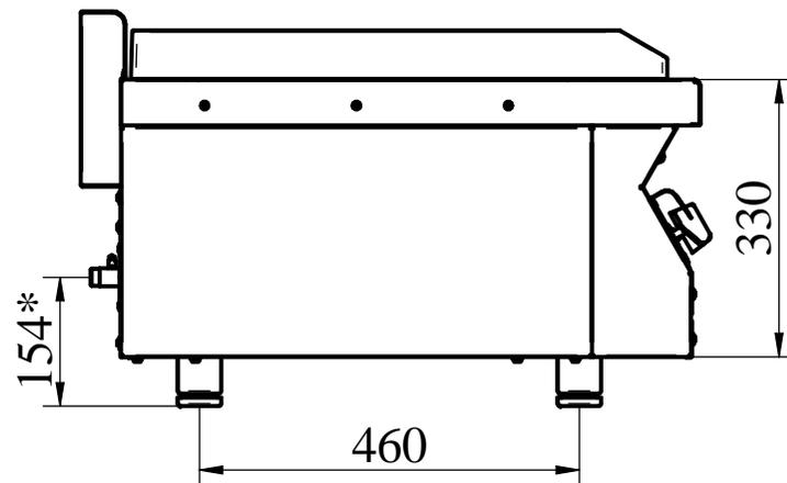
Аппарат газовый контактной обработки предназначен для приготовления пищи путем непосредственного контакта греющей чугунной поверхности с одной стороной обрабатываемого продукта, полуфабрикатов из мяса, рыбы, овощей, мелкоштучных изделий на предприятиях общественного питания, как самостоятельно так и в составе технологических линий. Работает как от природного так и сжиженного газа. Имеет регулируемые по высоте ножки.
