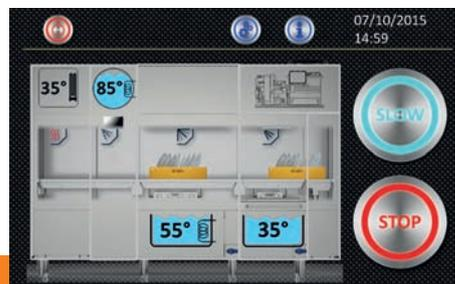
sualizzazione delle temperature, fasi di lavoro tramite immagini, stato della macchina, orario e eventuali anomalie. Indicatore dello stato della macchina visualizzato con differenti illuminazioni. Interfaccia USB per l'interscambio di dati. Registro della quantità di cicli effettuati giornalmente e nell'arco di vita della macchina.
