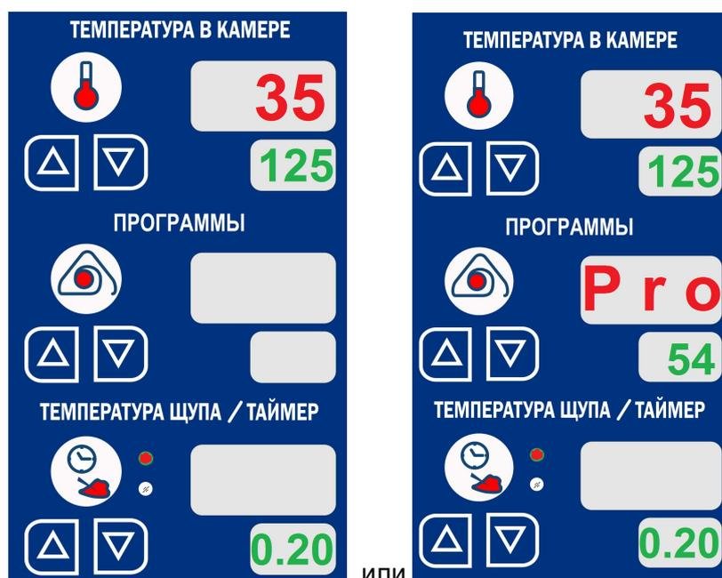
Для выбора режима готовки нажмите и отпустите кнопку соответствующего режима. Рядом с кнопкой загорается светодиод выбранного режима, а светодиод предшествующего режима должен погаснуть.
