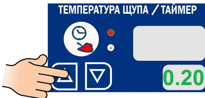
При значении заданного параметра «Таймер» равной 0.00 запуск пароконвектомата в работу невозможен.
