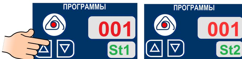
Установите параметры работы для всех шагов «Температура в камере», «Таймер»/«Температура щупа» (см. п. Готовка с параметром таймер и готовка с параметром температура щупа), «Влажность» (только для режима «Конвекция +Пар») и «Скорость».
