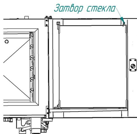
Используя бытовое средство для очистки стекол, очистите стекла. Закройте стекло и зафиксируйте его затвором;
