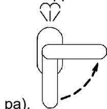
ра). При таком положении ручки механизм открывания двери блокирует возможность полного открытия двери.
