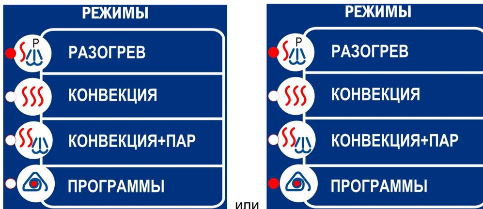
При включении пароконвектомата напротив надписи с названием режима загорается светодиод – работа по режиму. А если после включения пароконвектомата в поле режимы одновременно загорится светодиод одного из четырех режимов и светодиодом «Программы» (см. правый рисунок) это свидетельствует, что работа пароконвектомата будет выполняться по ранее сохраненным программам с установленными режимами и параметрами (см. п. Приготовления с использованием режима «Программа»).
