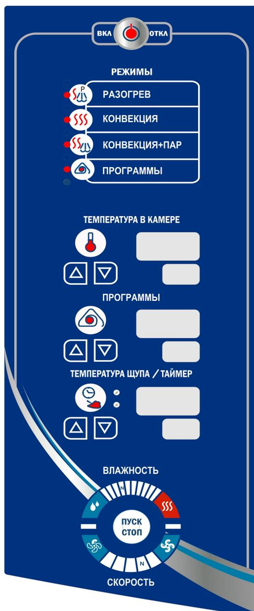
Рис. 1. Внешний вид панели управления
