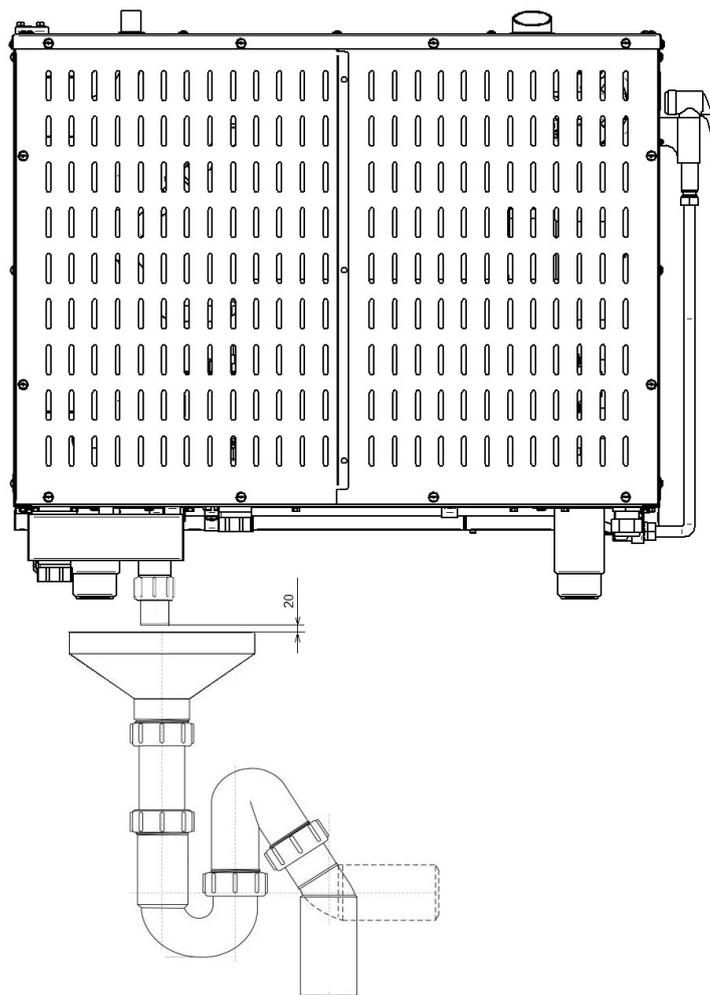
Рис. 14. Подключение к системе канализации
