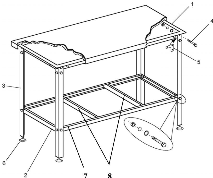
длинный швеллер (7) и два коротких швеллера (2) на стойках (3). Болтовые соединения не затягивать. Вставить в пазы на длинном швеллере перемычки (8). Закрепить нижний длинный швеллер (2) на двух коротких стойках, заправив в него свободные концы перемычек (8).
